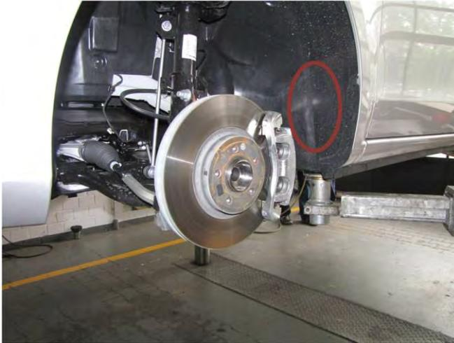
K13) An Achse 1 sind die Radhausauschnittkanten im Bereich von 45° vor und hinter der Radmitte komplett umzulegen und ggf. ins Radhaus ragende Kunststoffteile entsprechend zu kürzen.
