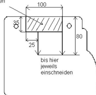
K44) Um eine ausreichende Freigängigkeit an Achse 2 herzustellen, sind die Radhausauschnittkanten im Bereich von ca. 100 mm unterhalb seitlicher Schutzleiste bis oberhalb Radmitte komplett umzulegen und der Filzinnenkotflügel in diesem Bereich hinter die gebördelte Radhauskante zu klemmen.
