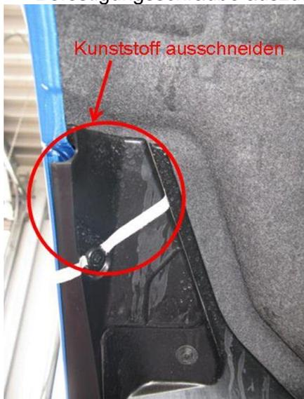
K67) Um eine ausreichende Freigängigkeit der Rad-Reifen-Kombination an Achse 1 zu gewährleisten sind folgende Maßnahmen erforderlich:
