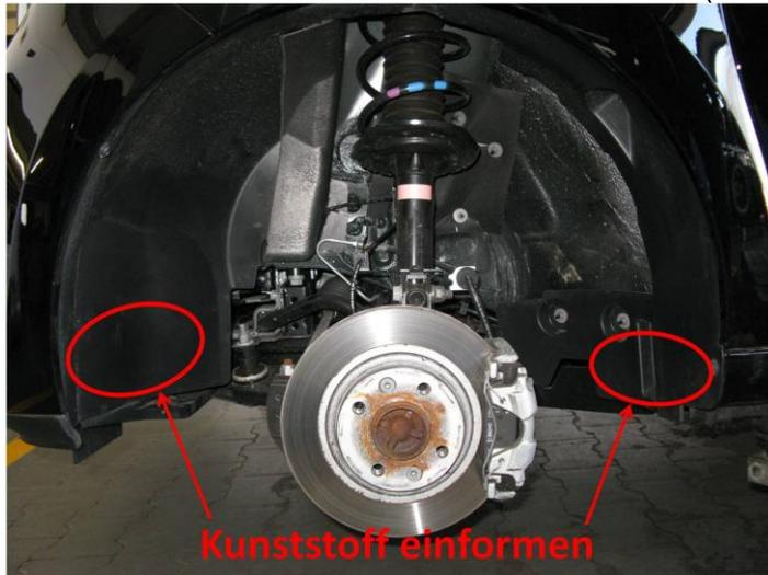
K89) Um eine ausreichende Freigängigkeit der Rad-Reifen-Kombination an Achse 2 zu gewährleisten sind folgende Maßnahmen erforderlich:
