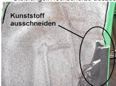
K64) An Achse 2 ist die ins Radhaus ragende Kante des Stoßfängers ab der Oberkante auf einer Länge von 30 mm entsprechend der umgelegten Radhauskante zu kürzen.
