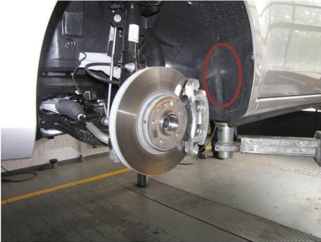
K13) An Achse 1 sind die Radhausausschnittkanten im Bereich von 45° vor und hinter der Radmitte komplett umzulegen und ggf. ins Radhaus ragende Kunststoffteile entsprechend zu kürzen.
