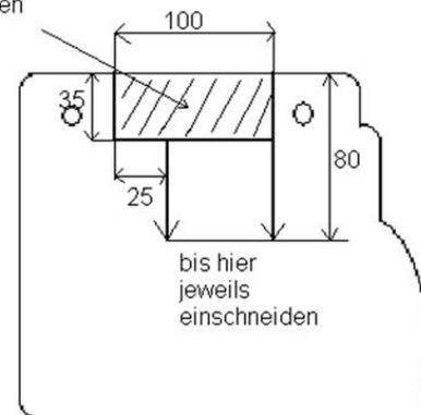
K44) Um eine ausreichende Freigängigkeit an Achse 2 herzustellen, sind die Radhausausschnittkanten im Bereich von ca. 100 mm unterhalb seitlicher Schutzleiste bis oberhalb Radmitte komplett umzulegen und der Filzinnenkotflügel in diesem Bereich hinter die gebördelte Radhauskante zu klemmen.
