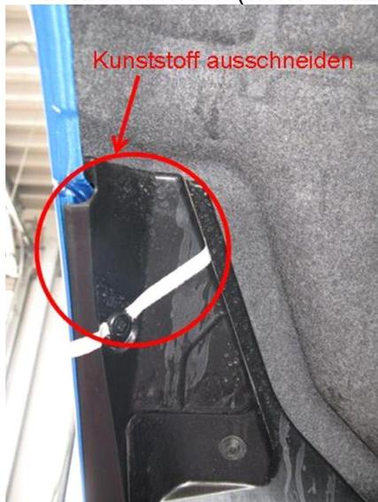
K67) Um eine ausreichende Freigängigkeit der Rad-Reifen-Kombination an Achse 1 zu gewährleisten sind folgende Maßnahmen erforderlich:
